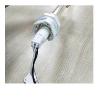
El conector tiene una posición para poder insertar, como se puede ver dos patas están más separadas que las otras dos, de tal manera que solo pueda insertarse de esa única manera.
