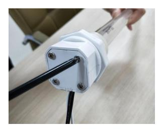
En esta imagen se puede apreciar la forma en que debe insertarse la lámpara dentro de la funda de cuarzo, la cual es la que estará en contacto con el agua.
